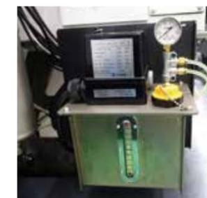
**自動間欠給油装置 / 自動グリス集中給脂装置**
