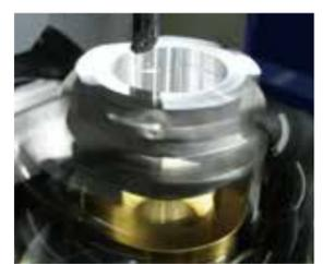
C軸を回転させた時、治具やワークのアンバランスに起因する振動を抑制することで、安定した回転動作を実現し加工精度低下を抑制します。
