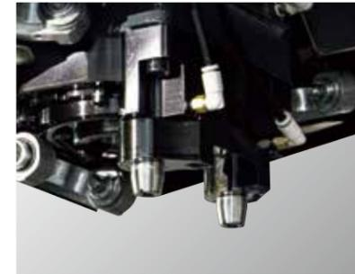
旋削工具の固定には独自のダブルプランジャーロック方式の採用により、高い工具交換繰り返し精度を実現しています。
