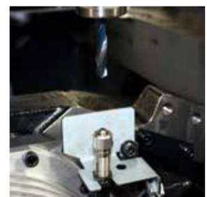
**工具折損検出装置 (タッチ式)**
