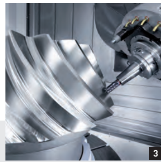
1: ターニング 2: タッピング 3: 汎用工具によるギヤ加工
