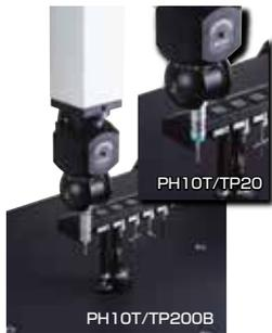
最大300 mmエクステンションに対応する自動首振りヘッドです。水平回転角度は±180°、垂直回転は0°~+105°で、7.5°ピッチで位置決めが可能です。TP200B仕様では、スタイラス長さ最大100 mm (GFスタイラス使用時)。エクステンションバー最大200 mm 使用可。
