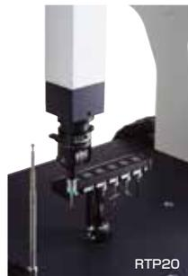
三次元測定機の動力を利用した自動首振りヘッドで、TP20を内蔵しています。(水平/垂直回転角度15°ピッチ)
