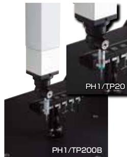
水平回転角度は15°ピッチ、垂直回転は任意の角度で固定が可能です。エクステンションバー最大200 mm使用可。TP200B仕様では、水平回転角度は15°ピッチ垂直回転は任意の角度で固定が可能です。(最大許容長さ測定誤差: EO, MPE(μm)2.2 + L/250)
